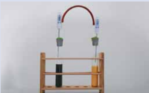
Abbildung 2: Reagenzglas B ist gefüllt mit Brausetablette und Leitungswasser
