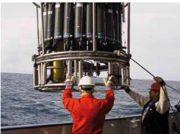
Abbildung 4: Mit Sonden, die an einen Kranzwasserschöpfer angebaut sind, messen Meeresforscher auch den pH-Wert der Ozeane.
