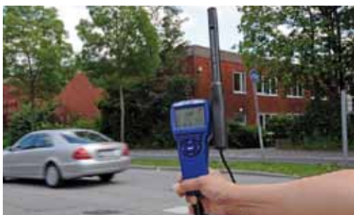
Abbildung 1: Um den Umgang mit dem CO 2 -Messgerät zu üben, kannst Du die Luft an verschiedenen Orten rund um die Schule und im Gebäude messen.
