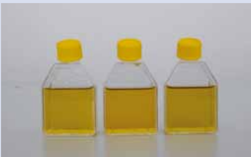
Abbildung 2: Mit der Atemluft wurde CO 2 hinzugefügt. Die gelbe Farbe bedeutet, dass das Wasser saurer geworden ist.
