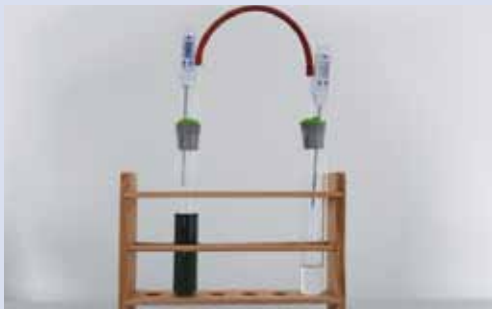
Abbildung 1: Reagenzglas A färbt sich grün durch Indikator
