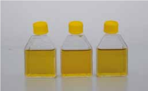
Abbildung 2: Mit der Atemluft wurde \text{CO}_2 hinzugefügt. Die gelbe Farbe bedeutet, dass das Wasser saurer geworden ist.
