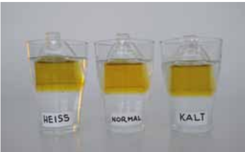
Abbildung 3. Die geöffneten Flaschen stehen in Wasserbädern mit verschiedenen Temperaturen.
