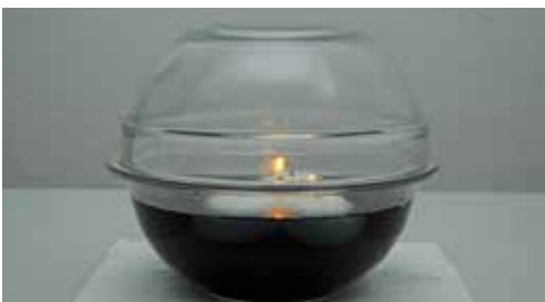
Abbildung 3: Die Schüssel mit den brennenden Kerzen ist mit einer zweiten Schüssel abgedeckt. Nach einigen Minuten erlöschen die Kerzen, weil sie allen Sauerstoff aufgebraucht haben.
